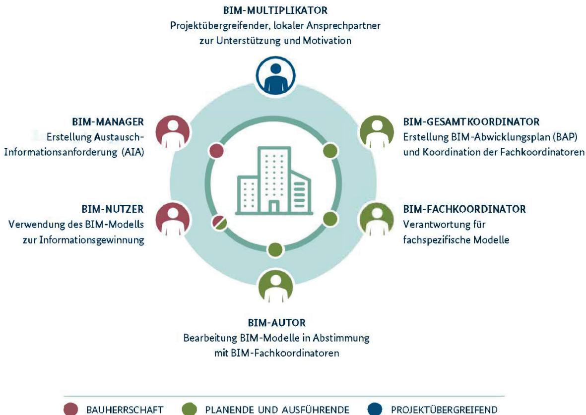
Abb. 3 BIM-Rollen gemäß Arbeitshilfe Rollensteckbriefe des BIM-Handbuchs für Bundesbauten [11]
